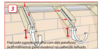
3. Ao instalar o sistema Classic no caibro do telhado, faça-o de lado ou no topo. Use parafuso e porca de M6 (pos. 20) e os suportes de caleira, a fim de ajustar facilmente a inclinação desejada da calha.
