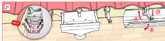
2 a . Coloque a caleira encaixando-a por baixo do suporte / gancho de caleira (A), verifique se o perfil de fixação está corretamente colocado e encaixe o bordo exterior da caleira no suporte / gancho de caleira (B). Não os fixe, pois isso permitirá o movimento da caleira em ambos os sentidos durante o processo de instalação. Aplicar uma camada uniforme de cola PVC-U apenas nas extremidades dos elementos a serem colados (C). A colagem deve ser efetuada consecutivamente a partir de uma união até um tampão. Certifique-se de que todos os elementos são colados, e finalize encaixando o suporte no lugar (D).
