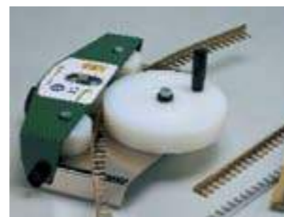
Proflex machine maquina manual para curvar os perfis Proflex line
